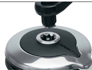
Wird eine Harken Kurbel mit Sicherung in die unbelastete Winsch eingesetzt, wird automatisch der Antrieb abgekoppelt für manuellen Betrieb.
