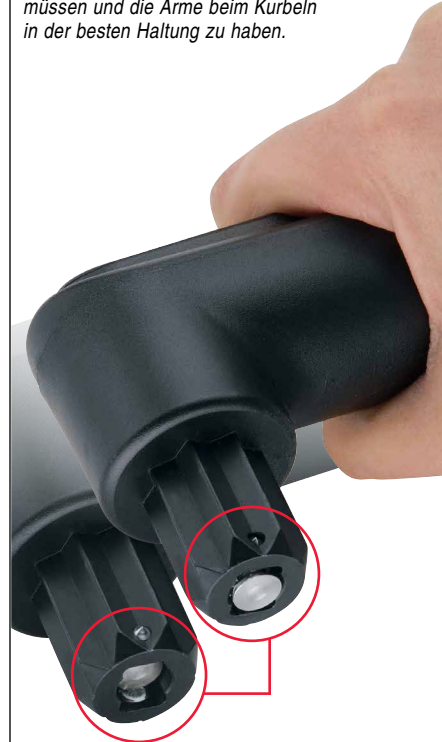
Der patentierte Verschlussmechanismus besitzt zwei Edelstahl Pins, welche sich automatisch zurückziehen, sobald der Auslösemechanismus betätigt wird. Wird der Verschlussmechanismus losgelassen, fahren die beiden Pins wieder aus, um eine solide und sichere Arretierung zu gewährleisten.
