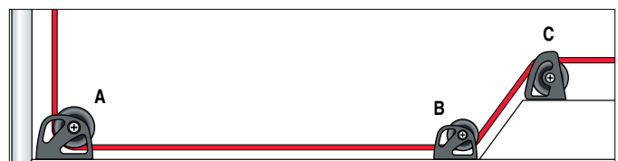
Over the Top: Besondere 'over-the-top' Blöcke kommen zum Einsatz, gilt es eine Aussenkante zu überwinden, wie die Vorderseite des Luken-Gehäuses oder das Süll.
