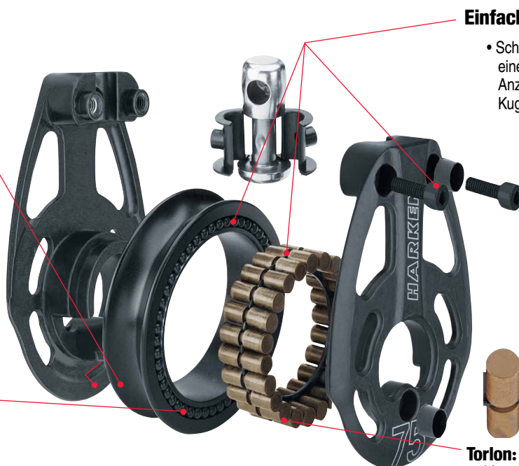
6061-T6 Aluminium: Hardcoat-eloxierte Seitenplatten und Scheiben
