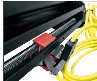
Die Schnecken-Konstruktion bringt den Antrieb nah an die Trommel, was die Winsch-Grösse reduziert.
