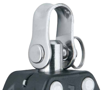
Die Sperre arretiert den Schäkel in frontaler oder seitlicher Stellung, oder lässt den Block frei drehen um ein Verwinden der Schot zu verhindern.
